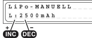
Bei diesem Programm wird der Akku mit dem eingestellten Kapazitäts-Ladestrom aufgeladen.
