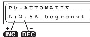
In diesem Programm erkennt das Ladegerät den angeschlossenen Akkutypen und passt den Ladestrom dementsprechend an, sodass eine Überlastung des Akkupacks verhindert wird.
