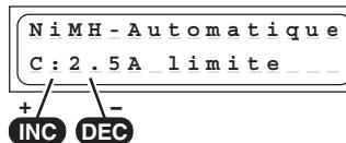
Dans ce programme, le chargeur détecte le type d'accu connecté et adapte le courant de charge en correspondance afin d'éviter une surcharge du pack d'accus. Le courant de charge maximum pourra être réglé avec les touches INC/DEC avant la connexion de l'accu à charger. La coupure de charge se fait d'après les valeurs réglées par l'utilisateur pour la "Tension de coupure NiCd-Delta-Peak", le „Retardement de la coupure de charge“ et le „Timer de sécurité“.
