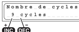
Le nombre de processus de charge/décharge à effectuer dans le 3 cycles programme de cyclage NiCd pourra être réglé. 1 à 10 cycles sont réglables.
