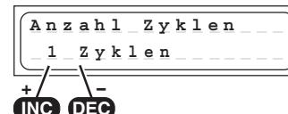
Die Anzahl der im NiCd-Formierungsprogramm angewendeten Lade-/Entladevorgänge können eingestellt werden. Es sind 1...10 Zyklen einstellbar.
