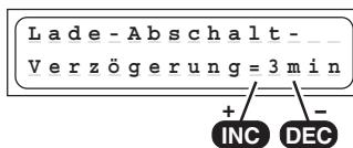
Nach dem Ladestart wird eine Verzögerungszeit gestartet, die eine Ladeabschaltung während dieser (Verzögerungs-) Zeit unterdrückt. Das heißt: Während dieser Zeit erfolgt **keine** Überwachung der Ladespannung, der Akku wird mindestens während dieser Zeit geladen! Die Ladeabfallverzögerung ist nur in den NiCd- und NiMH-Ladeprogrammen wirksam!
