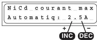
Le courant de charge maximal pour le programme de charge automatique sera pré-donné dans ce programme.
