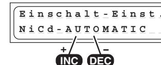
Welches Ladeprogramm automatisch aktiviert wird, wenn das Ladegerät eingeschaltet wird, kann eingestellt werden. Folgende Ladeprogramme stehen zur Verfügung: NiCd-Manuell -Automatic, NiMH-Manuell -Automatic, Lilo-Manuell, PB-Manuell.
