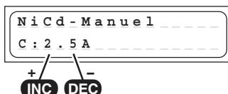
Avec ce programme, l'accu sera chargé avec le courant de charge réglé. Le courant de charge pourra être réglé avec les touches INC/DEC **avant** la connexion de l'accu à charger. La coupure de charge se fera après avoir réglé la tension de coupure "Delta-Peak-NiCd", le "Retardement de la coupure de charge" et le "Timer de sécurité" dans le programme "Régagements par l'utilisateur".
